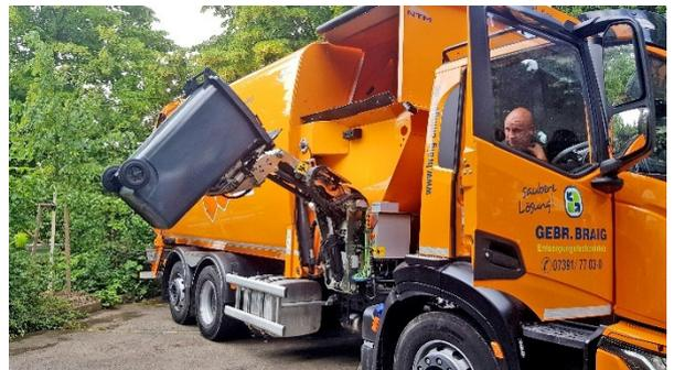
**Bitte Mülltüten nicht über den Rand der Tonne stülpen, sondern zur Leerung innen einschlagen (rechtes Bild). Sonst bekommt der Greifarm des Müllfahrzeugs (Bild unten) Probleme.**
